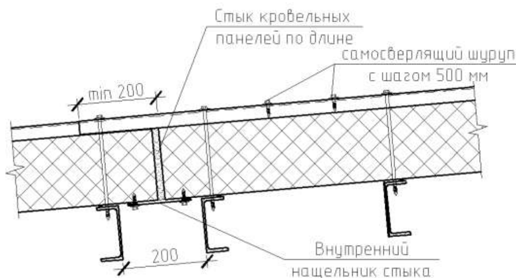
Рис.7. Стык кровельных панелей по длине.
